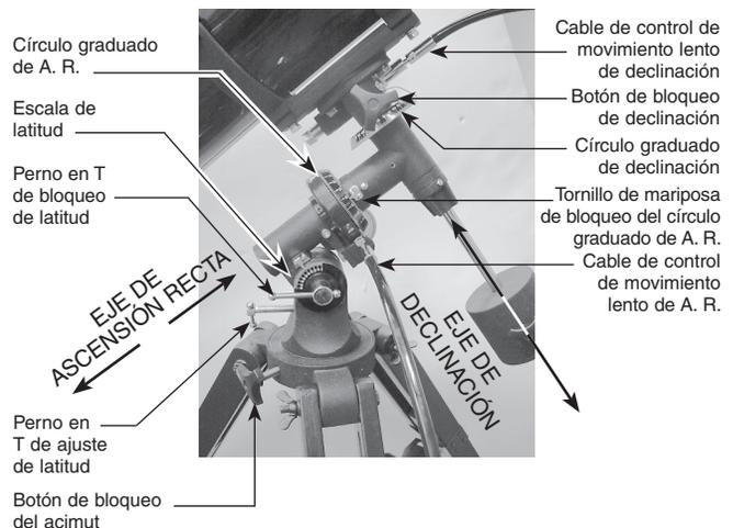
**Figura 2.** Montura ecuatorial del SpaceProbe 130 ST.
