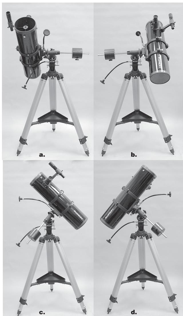
**Figura 7.** Esta ilustración muestra el telescopio apuntando a los cuatro puntos cardinales (a) norte (b) sur (c) este (d) oeste. Observe que el trípode y la montura no se han movido, solo se ha desplazado el tubo del telescopio en los ejes de ascensión recta y declinación.
