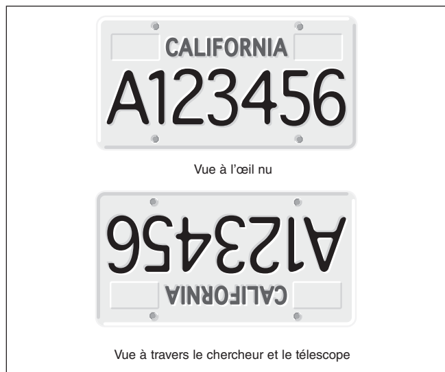
Figure 5. La vue à travers le chercheur et le télescope réflecteur est inversée. C'est également le cas pour le SpaceProbe130ST et son chercheur.
