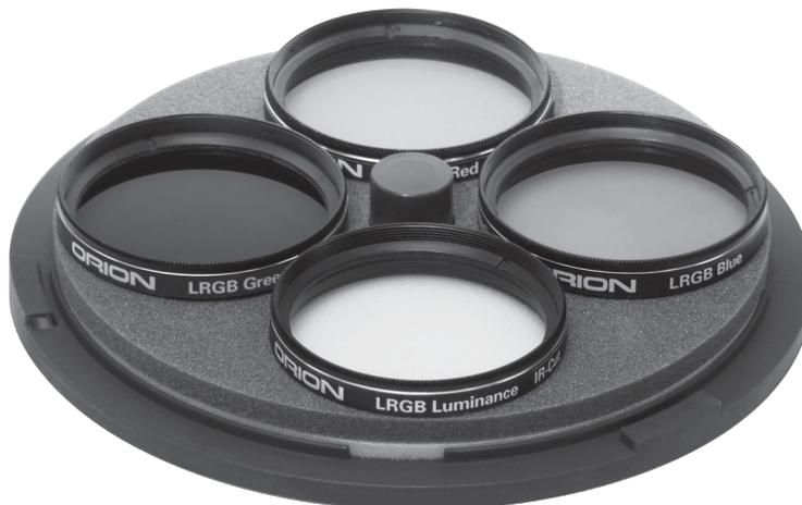
L'ensemble de filtres d'imagerie LRGB Orion 2 "comprend des filtres de luminance (L), rouge (R), vert (G) et bleu (B) qui vous permettent de créer de superbes images couleur composites d'objets du ciel nocturne lorsqu'il est utilisé avec une imagerie monochrome. Chaque filtre offre une ouverture claire de 43,2 mm qui convient aux caméras CCD de plus grand format.
